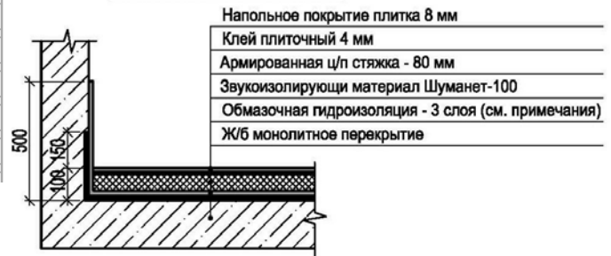
Конструкция пола ванной и кухни
